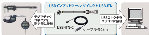
詳細はUSB-ITNのカタログNo.12007を参照ください 図1 USBインプットツール ダイレクトのシステム構成
