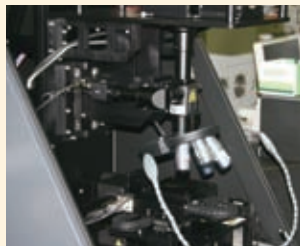
レーザー加工機に装着されたミットヨの長作動距離の対物レンズ
