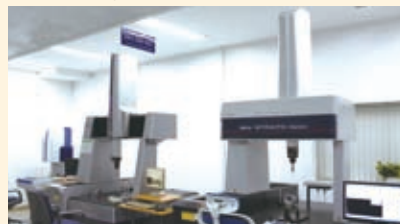
精密測定室のCNC三次元測定機2台
